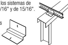
**UTC – Clip de agarre:** Para una conexión ajustada del sistema de suspensión a la canaleta de 1-1/2".
