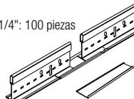
**Junta deslizante AXSJ-Axiom®** – Utilizada para unir dos sistemas de plafones acústicos en instalaciones Sísmicas D, E y F. También puede utilizarse para la unión de dos diferentes sistemas de plafones. Perforaciones para alambres de colgante a cada 6", iniciando a 3" en cada extremo.
