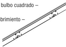
**Clip Espaciador Ajustable para Suspensión** – Utilizado para separar dos Tes principales paralelas a fin de permitir el equipamiento de luminarias, difusores de aire, etc.; permite ajustes de 1/4" con tres diferentes clips.
