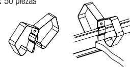
**UHDC – Clip de retención universal** Se sujeta al bulbo superior del sistema de suspensión para retener el plafón de orilla cuadrada de 1/16" a 5/8" en su lugar; ayuda a evitar el movimiento del plafón en las entradas.
