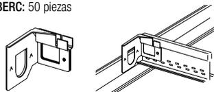
**Clip de junta sísmica – Te principal:** Permite que el plafón se divida en un empalme de la Te principal para áreas del plafón de más de 2500 pies cuadrados, a fin de tener juntas de separación sísmica.
