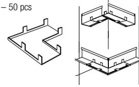
**7863 – Cubierta de Esquina Exterior** – Para moldura nominal en ángulo de 7/8"; broche embutido para equilibrar las esquinas exteriores; patas de 2".
